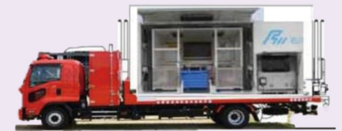
▲ 起震コンテナ(地震体験装置)
